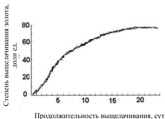
Рис. 5. Результаты полупромышленных испытаний по скоростному выщелачиванию золота из окисленной руды месторождения «Погромное» на пробе руды 6 т, дроблёной до крупности 10 мм в наислороженном цианидном растворе / Fig. 5. Results of semi-industrial tests on high-speed leaching of gold from the oxidized ore of the «Pogromnoe» deposit on a sample of ore 6 t, crushed to a size of 10 mm in acidified cyanide solution
